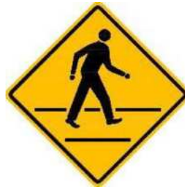
รูปที่ 6.2-7 ป้ายเตือนคนข้ามถนน ต.56 (ที่มา: คู่มือมาตรฐานป้ายจราจร กรมทางหลวง (2561))
