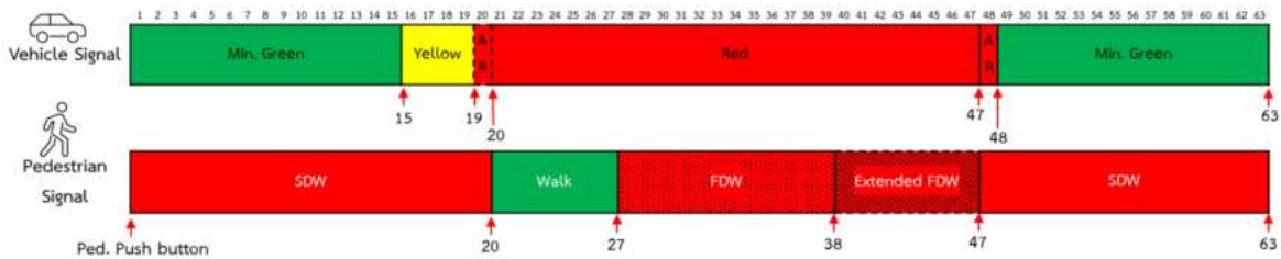
รูปที่ 6.2-20 ลำดับสัญญาณไฟของทางข้ามถนนกาญจนวนิช ทล.407 กม.24+700
